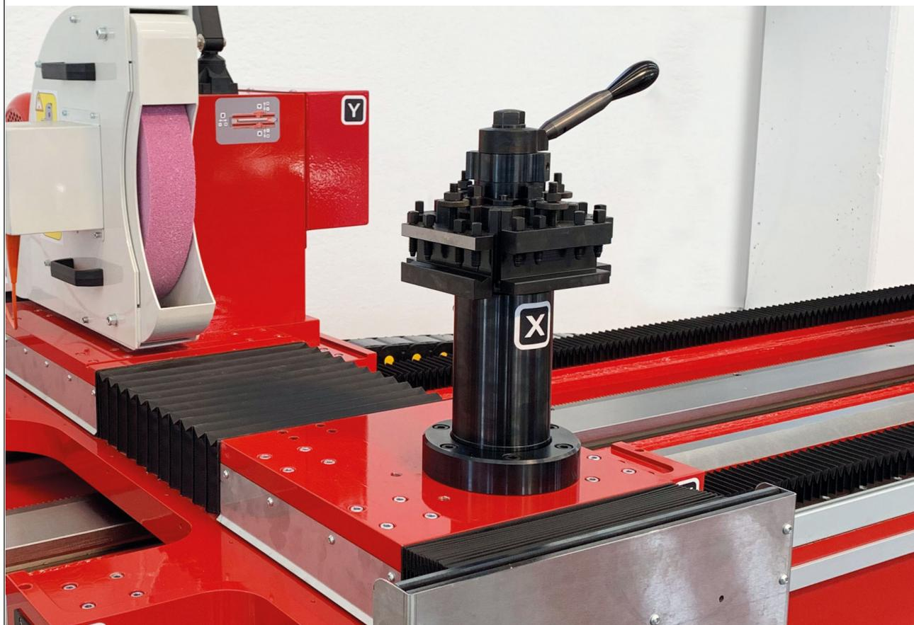
Zur Befestigung von bis zu 4 Werkzeugen für das Bearbeiten der Walzenoberfläche – bzw. Stirnseiten.
