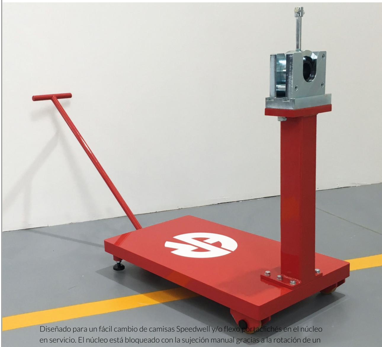
Diseñado para un fácil cambio de camisas Speedwell y/o flexo portaclichés en el núcleo en servicio. El núcleo está bloqueado con la sujeción manual gracias a la rotación de un excéntrico y posteriormente conectado al circuito de aire comprimido para el montaje / desmontaje de la camisa que luego se extrae frontalmente. El equipo se coloca normalmente en un área equipada con un puente grúa y/o un soporte de carga para levantar el núcleo y colocarlo en el dispositivo de sujeción.
