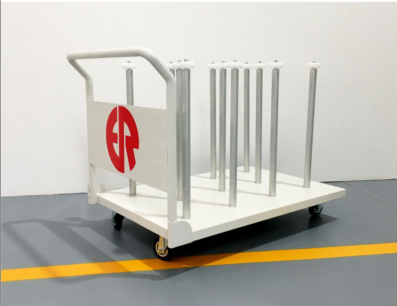
Progettati e realizzati per consentire una corretta movimentazione delle maniche nelle varie fasi produttive dal prelievo da magazzino (vedi anche Storage System Rossini), alla preparazione e montaggio lastra fino all'asservimento alla macchina da stampa; il posizionamento della manica sul carrello è guidato da inserti plastici. Solida struttura in acciaio elettro-saldato, verniciata e personalizzabile a seconda della esigenza del cliente (numero maniche e dimensioni).
