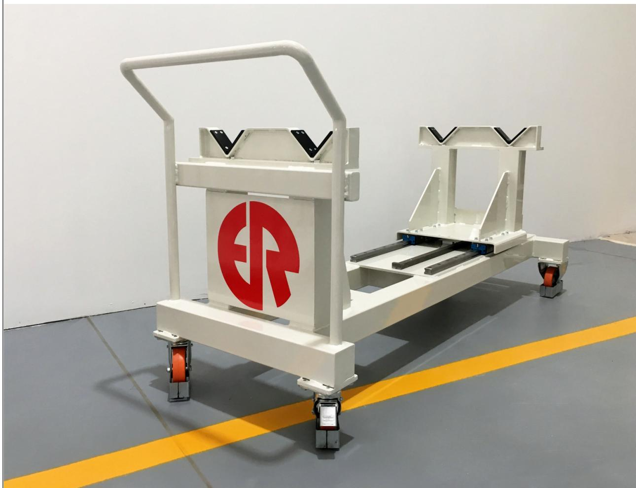
Principalmente pensato per asservimento alla rettifica PRIMA. Consente la movimentazione di due rulli (ad esempio uno in carico e uno in scarico dalla macchina al magazzino e/o al punto di utilizzo) in un range da 1100 a 1700 [mm] di lunghezza regolabile tra i supporti, con un diametro fino a 300 [mm] e un peso massimo trasportabile pari a 400 [kg]. Il carrello può essere impiegato per trasporto di mandrini, alberi, sleeves o anilox. Personalizzabile in funzione delle esigenze cliente.
