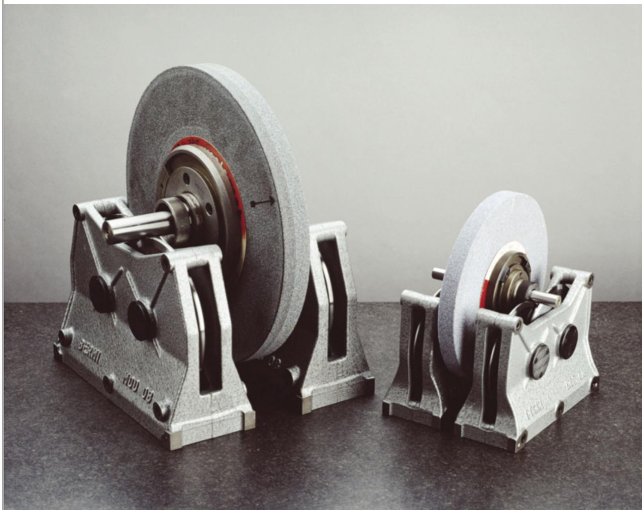
Strumento indispensabile per una corretta bilanciatura manuale di mole abrasive; attività frequente e necessaria per una corretta esecuzione del lavoro di rettifica. Una solida costruzione abbinata a una progettazione di cuscinetti speciali ideati per un particolare impiego fa sì che siano garantite le condizioni ideali per l'operazione di equilibratura. Completano la fornitura un albero per bilanciatura mola ed una flangia per mola per macchine Prima.
