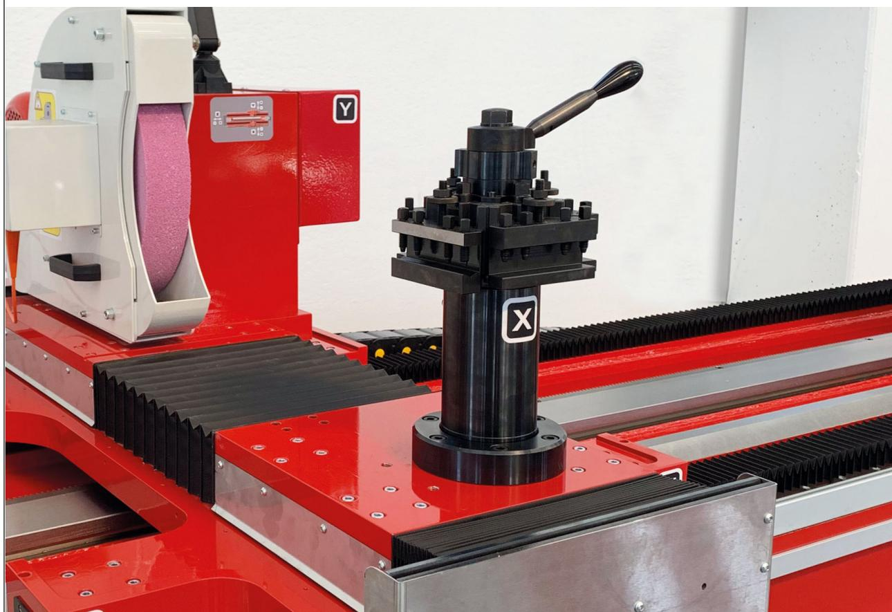
Projetada para equipar a máquina com até 4 utensílios para as diversas operações de corte, addressamento doreboloe intestatutura.
