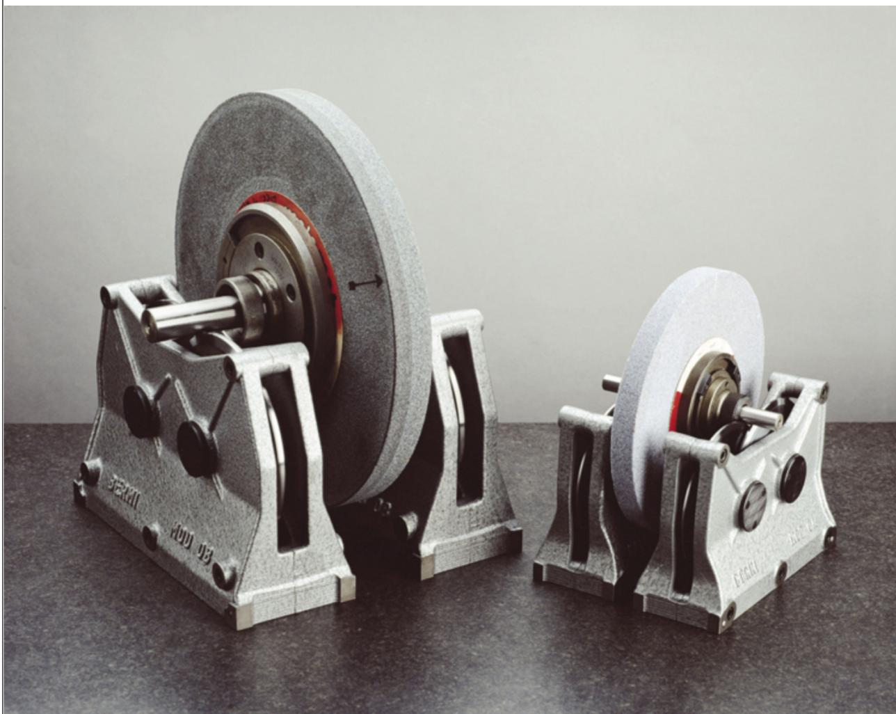
Instrumento indispensável para um balanceamento manual correto de rebolos abrasivos. Esta atividade é frequente e necessária para uma correta execução do trabalho de retificação. Uma sólida construção associada a rolamentos especiais ideais para o emprego, faz com que sejam garantidas as condições ideais para a operação de equilibragem. Completam o fornecimento um eixo para balanceamento da mola e uma flange para o rebole da máquina Prima.
